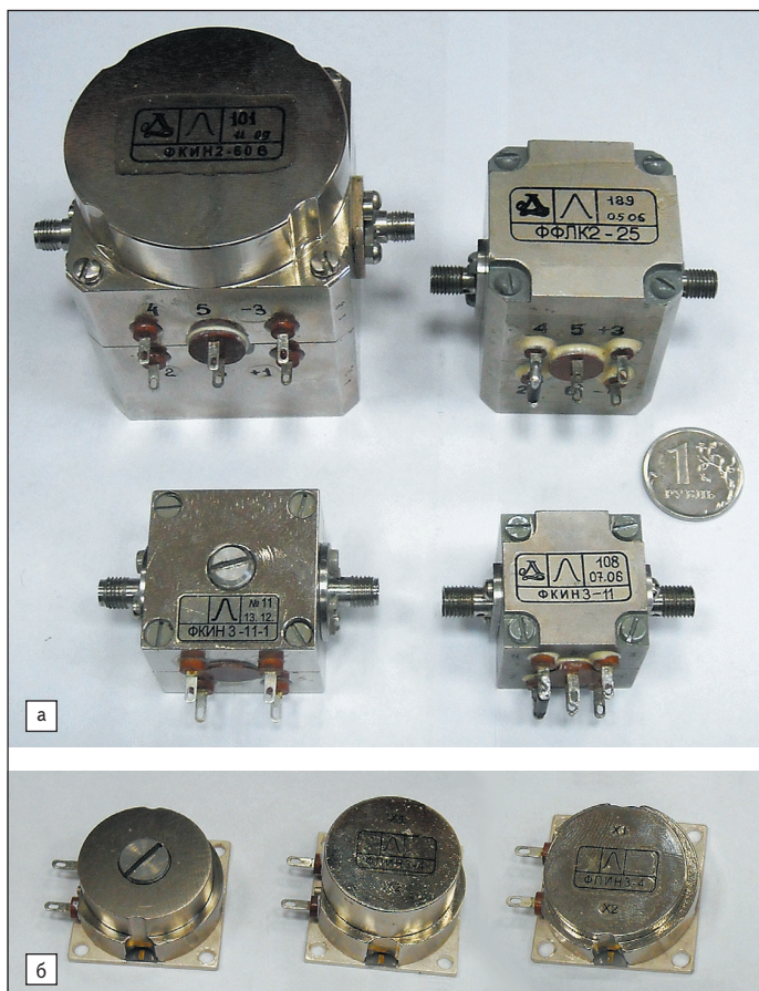
Рис. 5. Внешний вид ЖИГ-фильтров производства ОАО «Завод «Магнетон»: а) с коаксиальными выводами; б) с микрополосковыми
