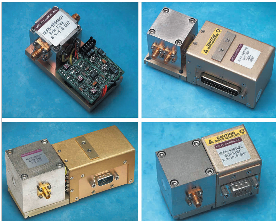
Рис. 3. Внешний вид ЖИГ-фильтров с аналоговыми и цифровыми драйверами питания катушки электромагнита
